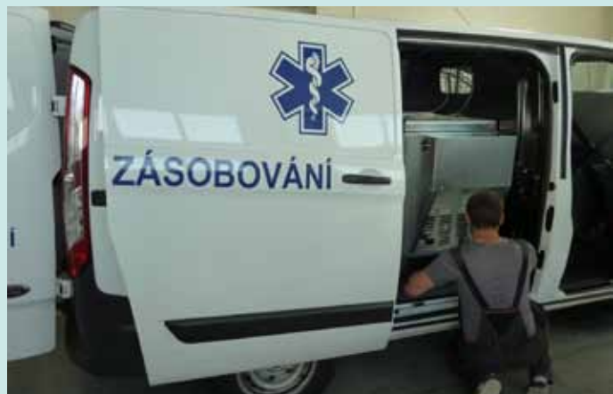
DOMETIC TL450 v úpravě DALIX s režimem chlazení/ohřev a záznamníkem teploty. Box je doplněn záložními bateriemi
